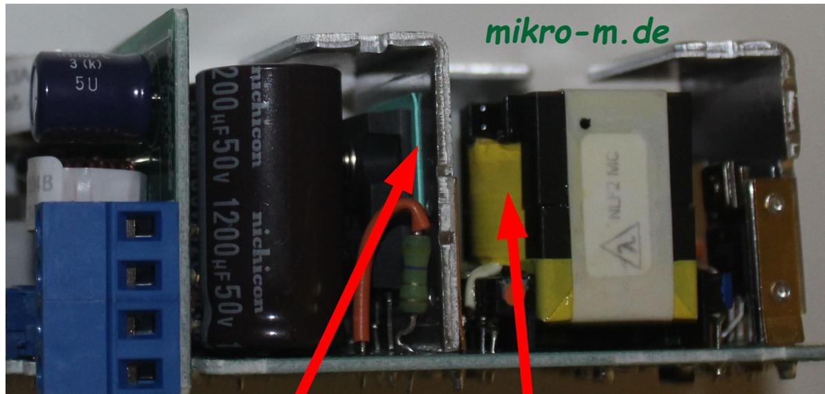
Ein Durchschlag der Isolierscheibe zwischen Schaltransistor und Kühlfläche oder
