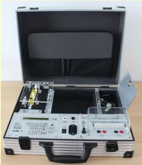
Der Prüfkoffer **A46** ist konzipiert für den automatischen Test kompletter Magazine
