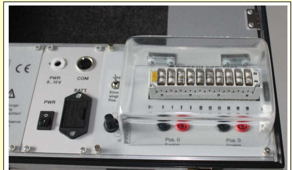
Einfach das komplette Magazin in den Prüfadapter (rechts im Koffer) einsetzen und **START** drücken.
