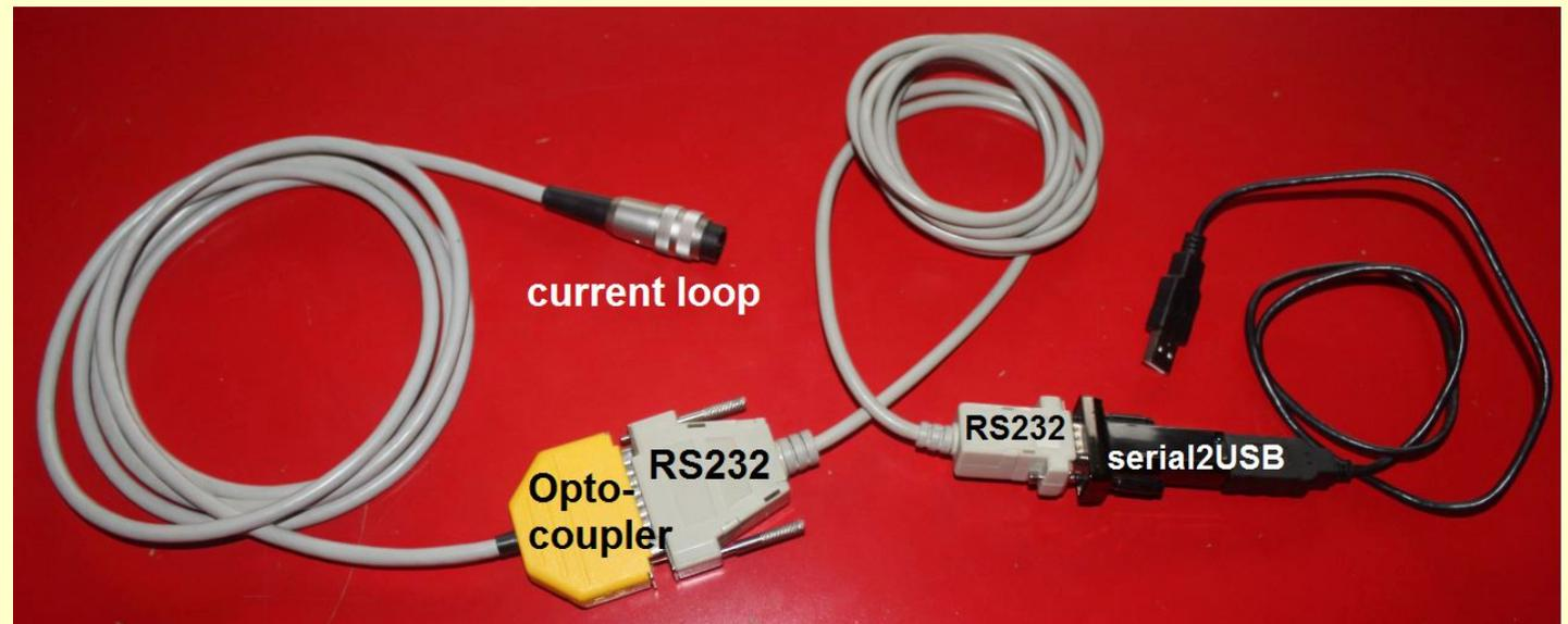
Das Verbindungskabel erlaubt die Kommunikation mit einem PC über eine serielle RS232-Schnittstelle oder über den USB und blendet Störimpulse aus, die z.B. beim Zünden von Gasentladungableitern entstehen. Das Prüfgerät verfügt über eine störteste digitale Stromschnittstelle, an die das Verbindungskabel angeschlossen wird.
