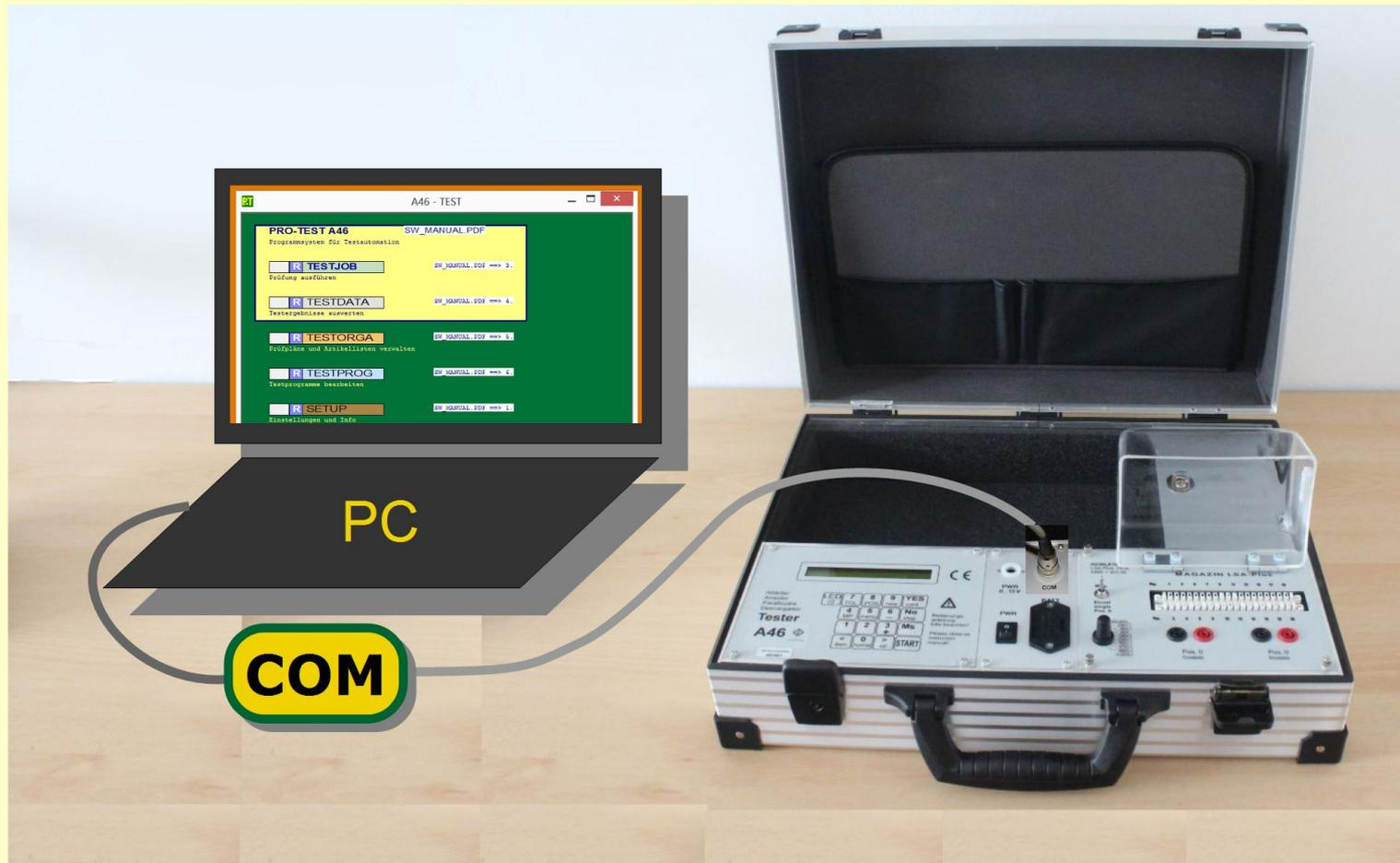
Die Software **TeSoDoc** steuert das Gerät komplett fern, führt die angeforderten Tests aus, erfasst die Daten revisionssicher und zeigt sofort nach jedem Test den Befund:
