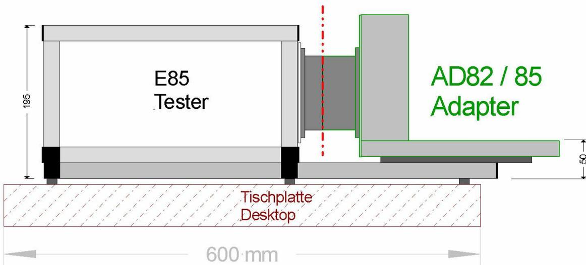
Das Spezialgehäuse des Testers ist mit den gleichen Profilen aufgebaut wie das Untergestell und kann leicht vom Untergestell getrennt werden, damit man den Tester zum Kalibrieren einschicken kann.
