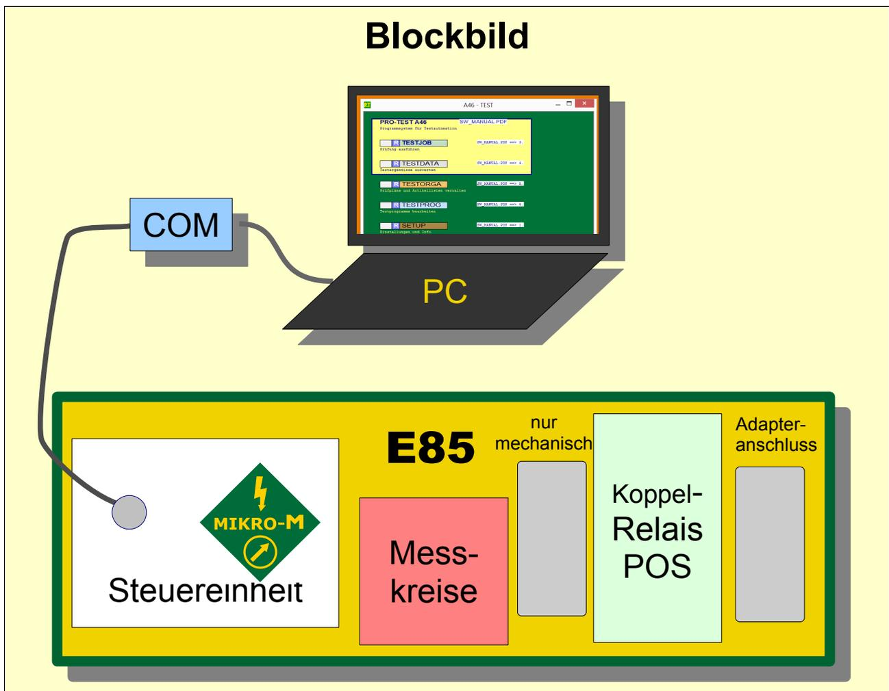
Über die eingebaute serielle Schnittstelle (COM) wird ein PC oder ein Tablet angekoppelt.
