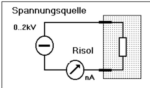
An den Prüfling wird eine Gleichspannung angelegt, einstellbar bis 2kV (optional 3kV, 5kV).
