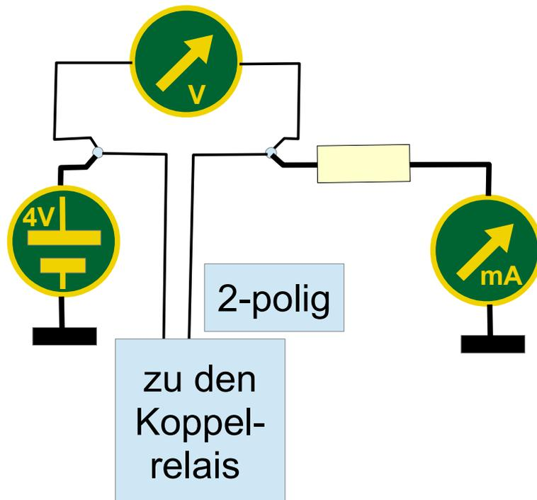
Widerstandsmessung in einer Halbbrücke mit 4V und Referenzwiderstand von 400Ohm.
