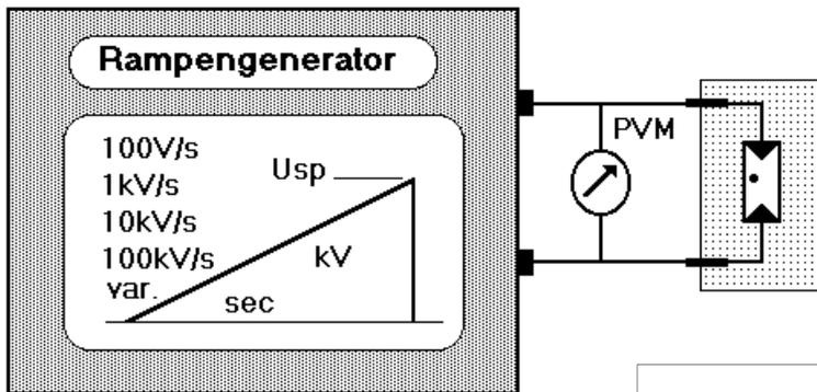
Die Spannung am Prüfling steigt linear mit der Zeit. Beim ersten Zünden wird die Spannung sofort abgeschaltet und die Zündspannung erfasst. Die Rampen sind elektronisch geregelt und über den Messbereich linear.
