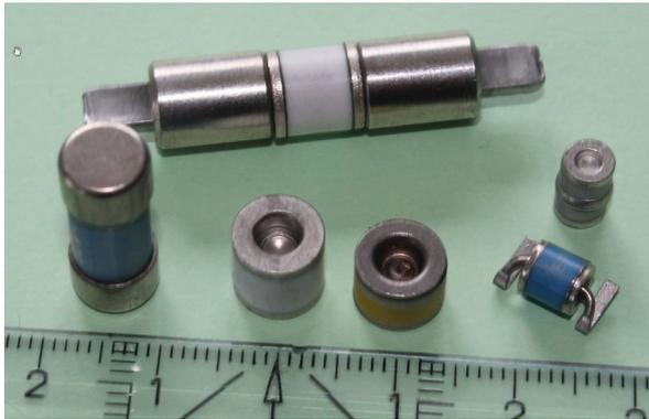
Die statische Ansprechspannung (**U<sub>ag</sub>**, **U<sub>z-stat</sub>**) wird allgemein für die Bemessung eines Gasentladungsableiters verwendet.
