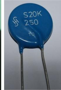
Im Datenblatt eines Zinkoxid-Varistors findet man unterschiedliche Spannungen.
